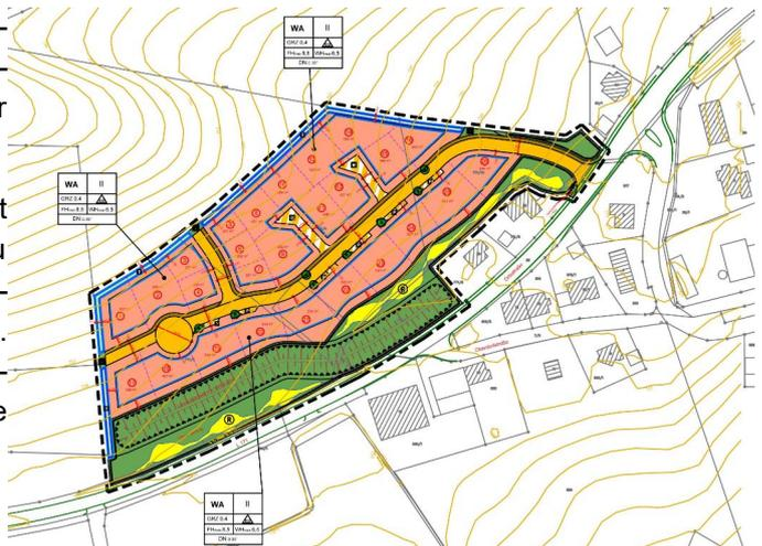
Das Plangebiet wird über eine Stichstraße an die Ortslage angebunden, entlang der L 171 (Ortsstraße) wird ein durchschnittlich ca. 25 m breiter Grünstreifen ausgewiesen, in dem ein Lärmschutzwall sowie Flächen zur Herstellung naturnah gestalteter Retentionsanlagen für das anfallende Oberflächenwasser untergebracht werden.
